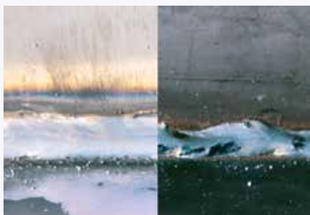
Vor dem Schweißen entzündete Oberflächen führen zu saubereren Schweißnähten (siehe Bild links)
