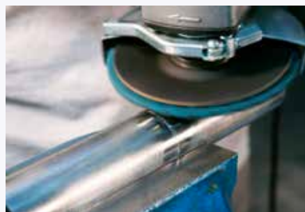
Schleifen feiner Schweißnähte und Entfernen thermischer Verfärbungen
