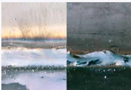
Les surfaces détartrées avant le soudage permettent d'obtenir des cordons de soudure propres (voir l'image de gauche).
