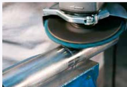
Poncer les joints de soudure fins et éliminer les décolorations thermiques
