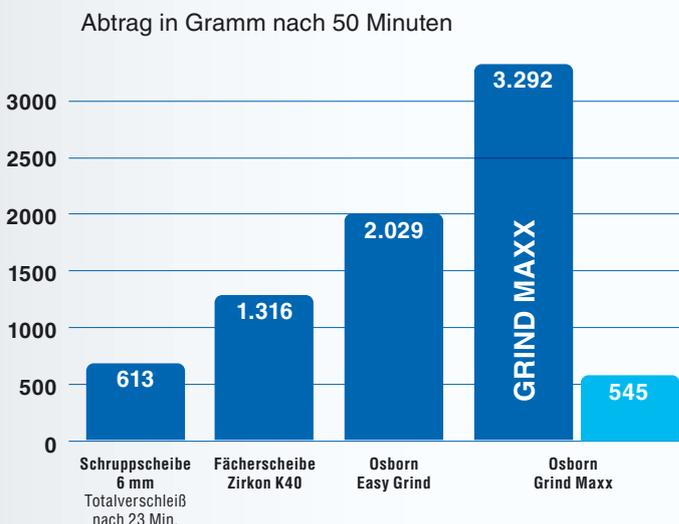
Abtrag in Gramm bis zum vollständigen Verbrauch des Schleifkorns
